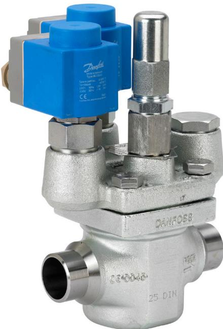
Двухступенчатые электромагнитные клапаны ICSH относятся к семейству ICV. Конструктивно клапан ICSH состоит из корпуса ICV, функционального модуля ICS и верхней крышки ICSH с двумя нормально закрытыми электромагнитными пилотными клапанами EVM.
