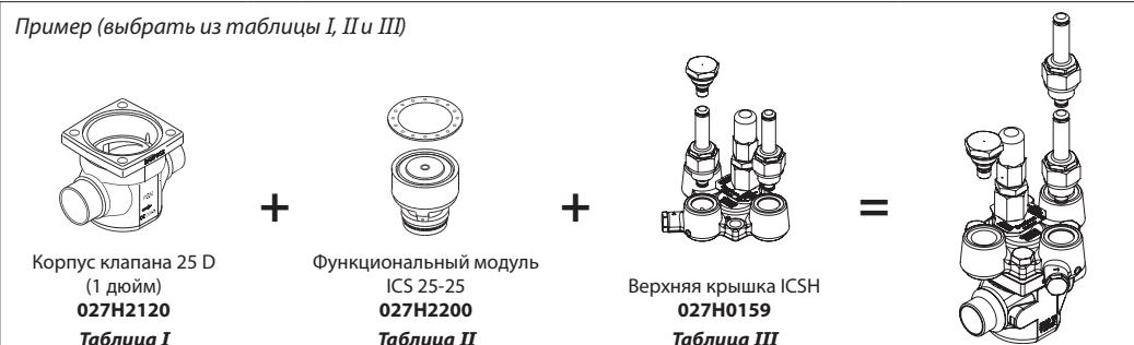
Корпус клапана ICV 25 с различными присоединениями Таблица I
