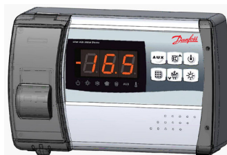
Obr. 8 Uzavřete přední panel a ujistěte se, že všechny vodiče jsou uvnitř a že těsnění skříňky je správně na svém místě. Připevněte přední panel za použití 4 šroubů. Zapněte panel a pečlivě proveďte programování všech parametrů.
