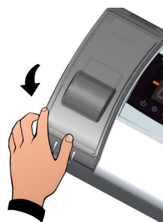
Obr.3 Vratte zpět průhlednou ochranu proudového chrániče.
