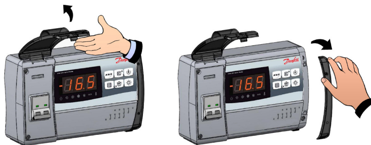
Obr.1 Zvedněte průhledný kryt, který stíní proudová chránič a odstraňte kryt šroubů na pravé straně.
