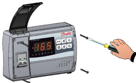
Obr. 2 Uvolněte 4 připevňovací šrouby z čela skříňky.
