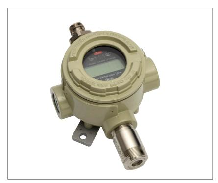
Die Gaswarngeräte Heavy Duty dienen zur Überwachung von und Warnung vor gefährlichen Gaskonzentration. Sie sind für ATEX/IECEX Anwendungen konzipiert und bestehen aus einem robusten, feuerfesten Metallgehäuse, das nach der Verkabelung geschlossen bleiben kann, da die Programmierung (Konfiguration) mittels eines Magnetstifts erfolgt. Je nach Anwendung gibt es sie mit einem elektrochemischen, einem Halbleiteroder einem Pellistor-Sensor, um einen großen PPM-Bereich abzudecken.
