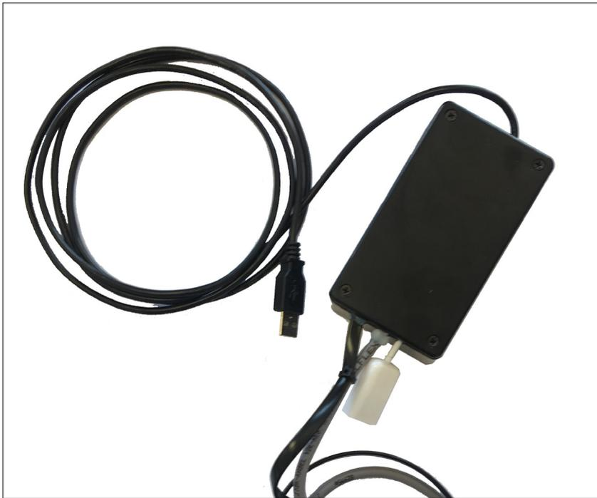
Das Gaswarn-PC-Tool ist eine menügesteuerte und eigenständige Software für eine einfache Adressierung, Parametereinstellung und Datenprotokollierung der Gaswarngeräte Basic, Premium und Heavy Duty Gaswarngeräten. Außerdem steuert es die Parametereinstellung und das Auslesen des Speichers der Gaswarnregler sowie deren Peripheriegeräte (Erweiterungsmodul, Warnmodul). Die Stromversorgung dieses Tools erfolgt vom PC über einen Standard-USB-Anschluss.
