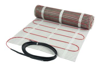
ECmat ist eine extrem hochqualitative Heizmatte. Die Zweileiterheizleitung verfügt über eine 360°-Abschirmung und eine robuste rote PVDF-Außenisolierung. Die robuste Konstruktionsweise und die geringe Aufbauhöhe von 3,5 mm ermöglichen eine schnelle, unkomplizierte und sichere Installation, speziell auch bei der Renovierung bestehender Fußböden. Die deutlich erkennbare Übergangsmuffe von der Heizleitung auf den Kaltleiter vermeidet eine unbeabsichtigte Installation der Heizleitung in der Wand.
