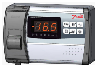
Fig 8. Luk frontpanelet, og sørg for, at alle ledningerne er inde i boksen, og at boksens forsegling sidder sikkert i position. Spænd frontpanelet ved hjælp af de fire skruer. Tænd panelet, og læs/programmér omhyggeligt alle parametre.
