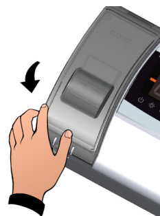
Abb. 3 Den transparenten Schutz des magnetothermischen Leistungsschalters schließen.
