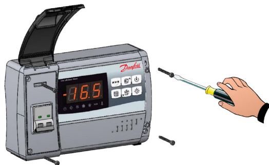
Bild 2. Lossa de 4 fästskruvarna på framsidan av skåpet.
