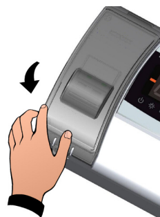
Bild 3. Stäng det genomskinliga locket till den magnettermiska krets brytaren.
