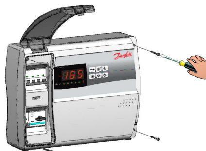
Fig 19. Spænd frontpanelet ved hjælp af de fire skruer. Genmonter skruedækslet i højre side.
