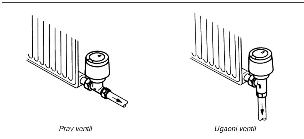
FJVR se montira na izlaznom priključku radijatora. Pri montaži potrebno je ventil postaviti u tako da se smer strujanja i strelica na ventilu poklapaju.
