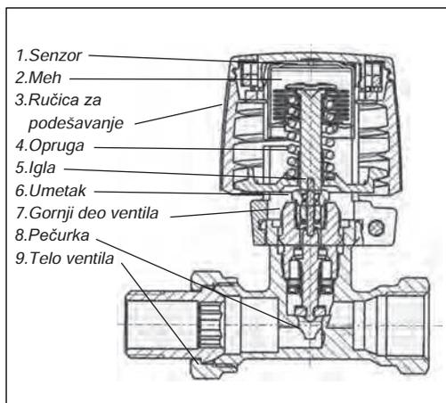
Limiter povratne temperature sastoji se od termostatskog pogona i ventila koji se poručuju zasebno. Umetak ventila može se menjati bez pražnjenja instalacije.
