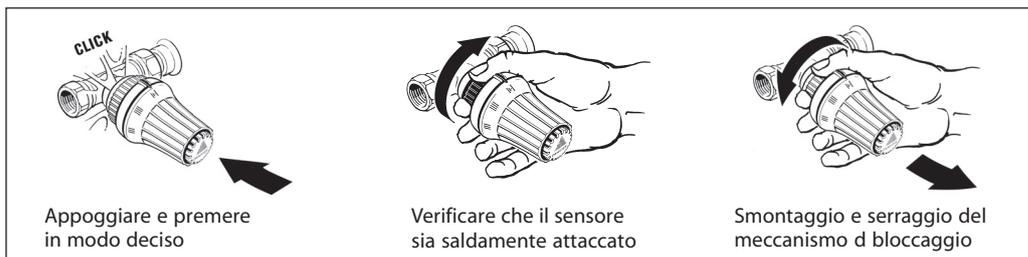
Il montaggio del sensore sul corpo valvola è molto semplice, non è necessario utilizzare alcun utensile: è sufficiente appoggiare il sensore e premere. Un anello di serraggio permette all'attacco di fissarsi automaticamente a scatto sulla valvola quando si preme. L'articolo viene fornito con il meccanismo di
