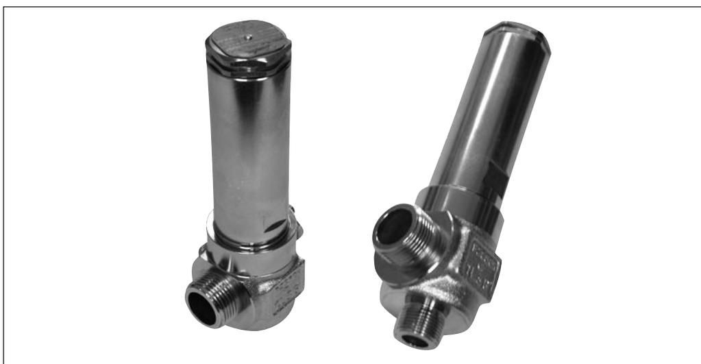
Les SFA sont des soupapes de sécurité à passage d'équerre dont l'actionnement dépend de la contre-pression. Elles sont spécialement conçues pour protéger les réservoirs et autres composants contre les pressions excessives.
