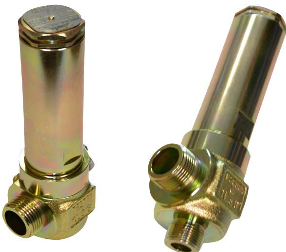
SFA 15 и SFA 15-50 – это стандартные, зависящие от **противодавления** предохранительные клапаны углового исполнения, предназначенные для защиты сосудов и других элементов системы охлаждения от слиш-ком большого давления. Клапан SFA 15-50 имеет уменьшенную на 50% производительность по сравнению с клапаном SFA 15.
