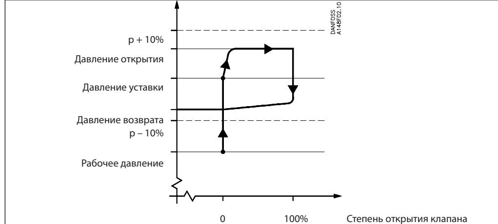
Клапаны SFA выпускаются как стандартные предохранительные клапаны для холодильных установок. При увеличении давления в системе выше уставки давления предохранительный клапан начинает открываться, сначала ненамного, чтобы пропустить минимальный расход хладагента. Если давле-
