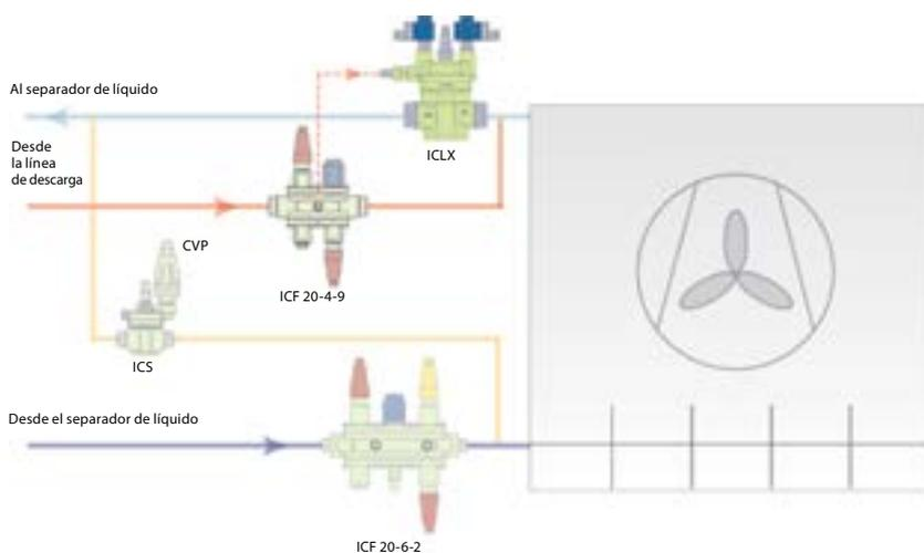
Las válvulas ICLX se instalan en líneas de retorno y aspiración húmedas para garantizar la apertura contra presiones diferenciales elevadas, como las que tienen lugar tras un desescarche por gas caliente en sistemas de refrigeración industrial de grandes dimensiones con amoníaco o refrigerantes fluorados.
